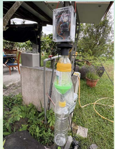
圖 11 / 東方果實蠅自動化誘引計數模組：結合費洛蒙誘引與物聯感測技術進行精準計數
