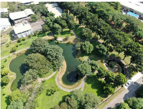
▲ 映霞湖，為本校人工濕地及水生植物復育區，同時也是處理學校生活汙水的生態池，汙水經環境保護暨安全衛生中心處理後會排放至映霞湖，透過生物氧化、人工溼地和水生植物進行汙水淨化處理
